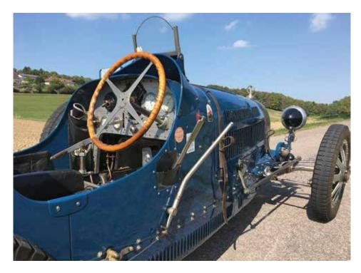
bronzine. L'alimentazione era affidata a due carburatori Solex, ma in alternativa potevano essere impiegati anche gli Zenith. Fu costruita fino al 1929 in 139 unità. L'accensione a magneto fu, più tardi, convertita con spinterogeno, batteria e bobina. Le ruote erano a raggi.
