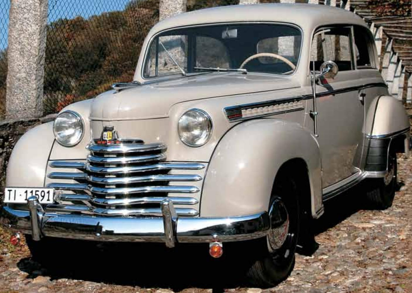
**La nostra vettura** ► Si tratta di una Opel Olympia 1952 Limousine, di proprietà del signor Riccardo Schlee di Bellinzona. È l'ultima evoluzione della serie dopo quella del 1938 (con il nuovo motore da 1,5 litri e 37 CV DIN, poi ripresa praticamente uguale nel 1947) e quella del 1950. È spinta da un motore 4 cilindri in linea, a 4 tempi, raffreddato ad acqua con circolazione forzata. I suoi
