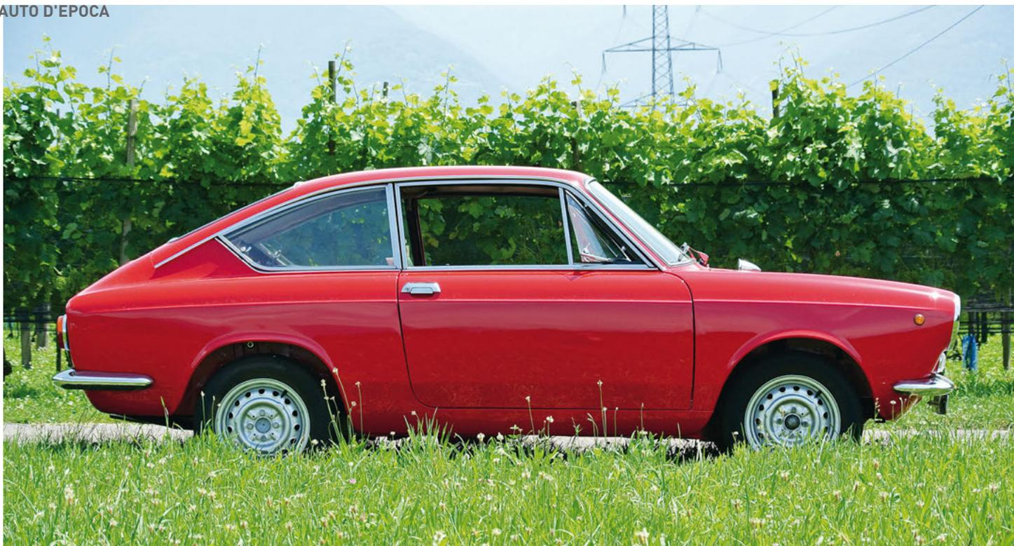
scarico. Fu inoltre adottato un carburatore doppio corpo Weber, per aumentare la potenza a 47 CV e offrire prestazioni di tutto riguardo: 135 km/h di velocità massima e ottime doti sullo spunto. La Spider, con un paio di CV in più, toccava i 145 km/h.
